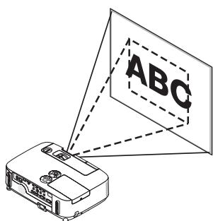
投写画面の左右の傾き調整
