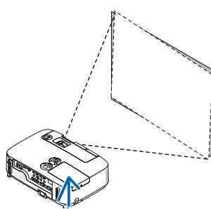
投写画面の台形歪み補正【台形補正】
