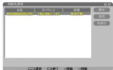
**9 接続先のコンピュータをクリックし、[確定] をクリックする。**
