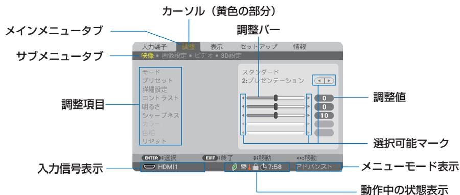
🌿 エコモード設定、🌬️ ファンモードの「高地」設定、🔴 強制エコモード、🔒 本体キーロック中、🕒 8:00 オフタイマーの残り時間のアイコン
