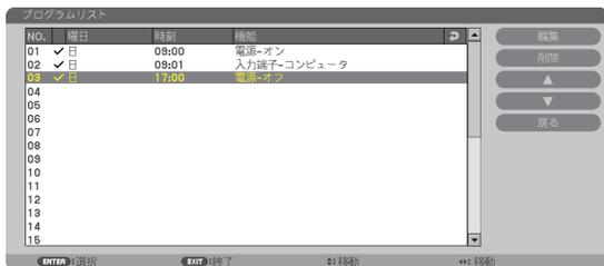
曜日や時刻を設定することにより、本機の電源オン／スタンバイや映像信号の切り替え、およびエコモードの切り替えを自動で行うことができます。たとえば、上の画面の設定では、日曜日の9時に電源がオンになり、9時1分にコンピュータの画面に切り替わり、17時に電源がスタンバイ状態になります。
