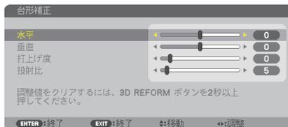
台形補正画面を表示するには、オンスクリーンメニュー→表示→幾何学補正→台形補正を選択します。幾何学補正画面はリモコンの(Geometric.)ボタンを押しても表示できます。
