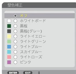
映像を投写する面がスクリーンではなく、部屋の壁などの場合、メニューから壁の色に近い項目を選択すると、壁の色に適應した色合いに補正して投写できます。
