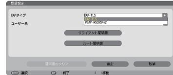
EAP タイプは、「EAP-TLS」または「PEAP-MSCHAPv2」を選択でき、EAP タイプによって設定項目が異なります。次の表を参照してください。
