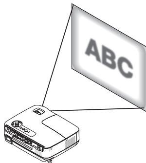
投写画面の台形歪み補正【台形補正】 6ページ
