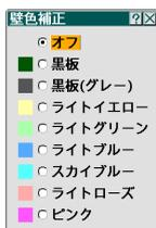
画像を投写する面がスクリーンではなく、部屋の壁などの場合、メニューから壁の色に近い項目を選択すると、壁の色に適応した色合いに補正して投写できます。
