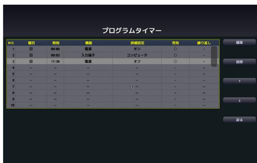
曜日や時刻を設定することにより、本機の電源オン／スタンバイや映像信号の切り替え、およびエコモードの切り替えを自動で行うことができます。たとえば、上の画面の設定では、日曜日の9時に電源がオンになり、9時3分にコンピュータの画面に切り替わり、17時30分に電源がスタンバイ状態になります。
