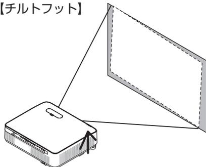
投写画面の台形歪み補正【台形補正】
