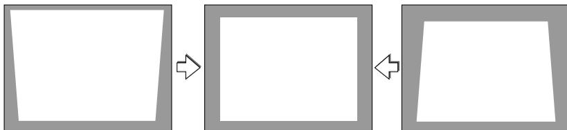
画面の左右（水平方向）が歪んでいるときは、レンズ面がスクリーンに平行になるように設置しなおします。
