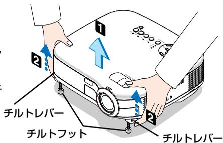
3 チルトレバーを押したまま、本機の投写角度および左右の傾きを調整する。
